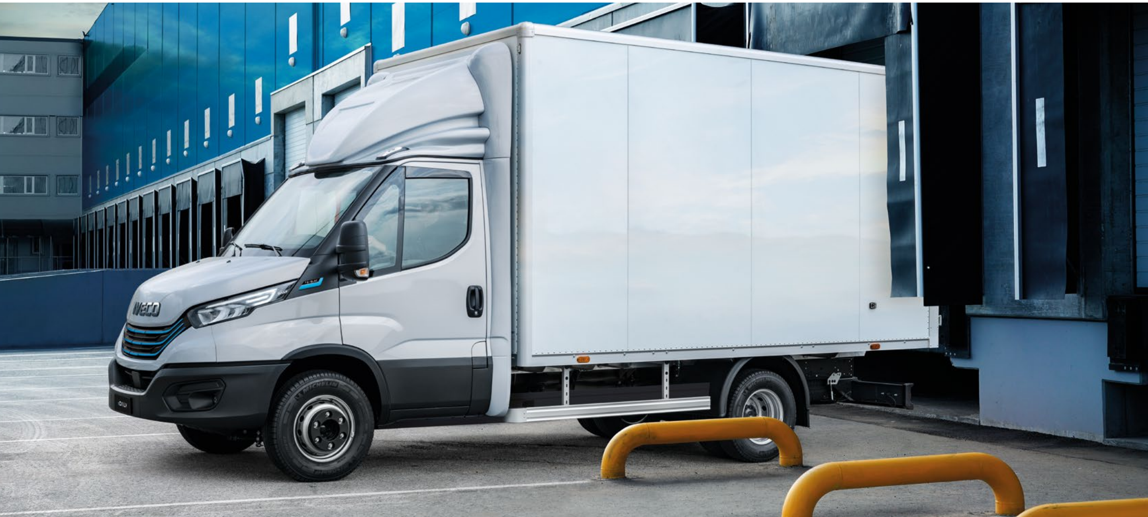
Karosserie in Leiterrahmenbauweise (Body-on-frame)
